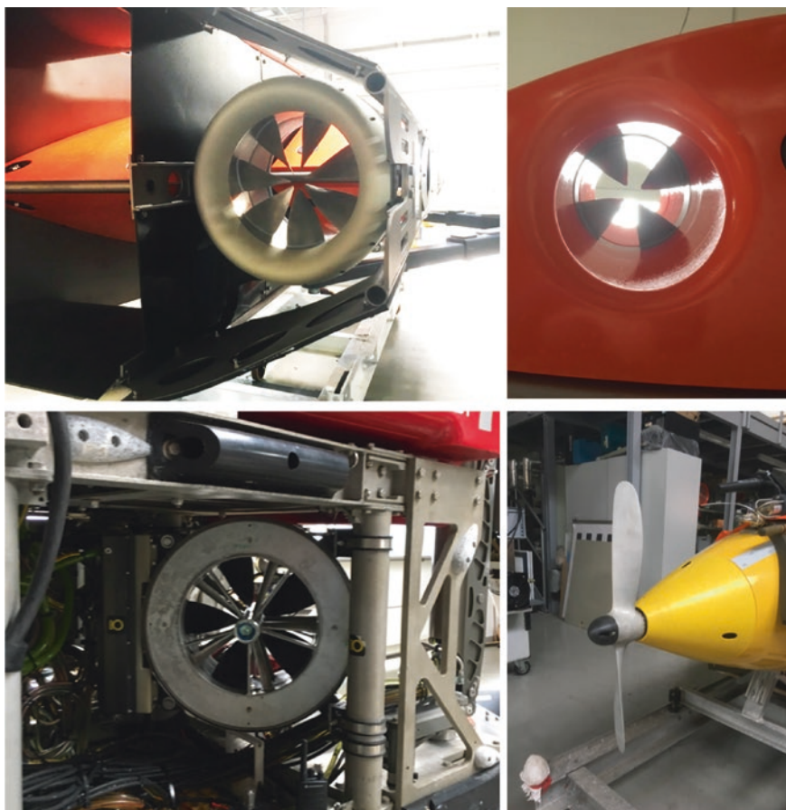
Abb. 1 Beispiele für Unterwasserantriebssysteme. Obere Reihe: Ringpropeller. Linkes Bild: Hauptantriebsschubdüse (Innendurchmesser: 266 mm). Rechtes Bild: Tunnel-Thruster-Konfiguration (Innendurchmesser: 160 mm). Untere Reihe: Linkes Bild zeigt axial gestützten Ringpropeller; rechtes Bild zeigt einen konventionellen axial angetriebenen Propeller für ein AUV. (Quelle: MARUM, Universität Bremen, Deutschland)
