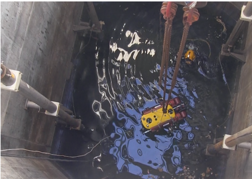
Abb. 1 Beispiel für eine Mission in einer begrenzten Unterwasserumgebung. Das AUV Dagon wird in den Kühlwasserschacht eines Kraftwerks abgesenkt [14]. (Bild mit freundlicher Genehmigung von Marc Hildebrandt, DFKI)
