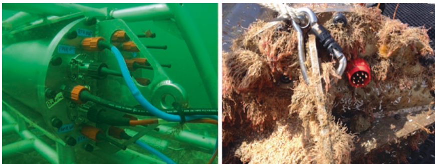
Abb. 10 Kernelement des Unterwasserknotensystems kurz nach der Exposition (linkes Bild) und nach 8 Monaten unter Wasser (rechtes Bild)
