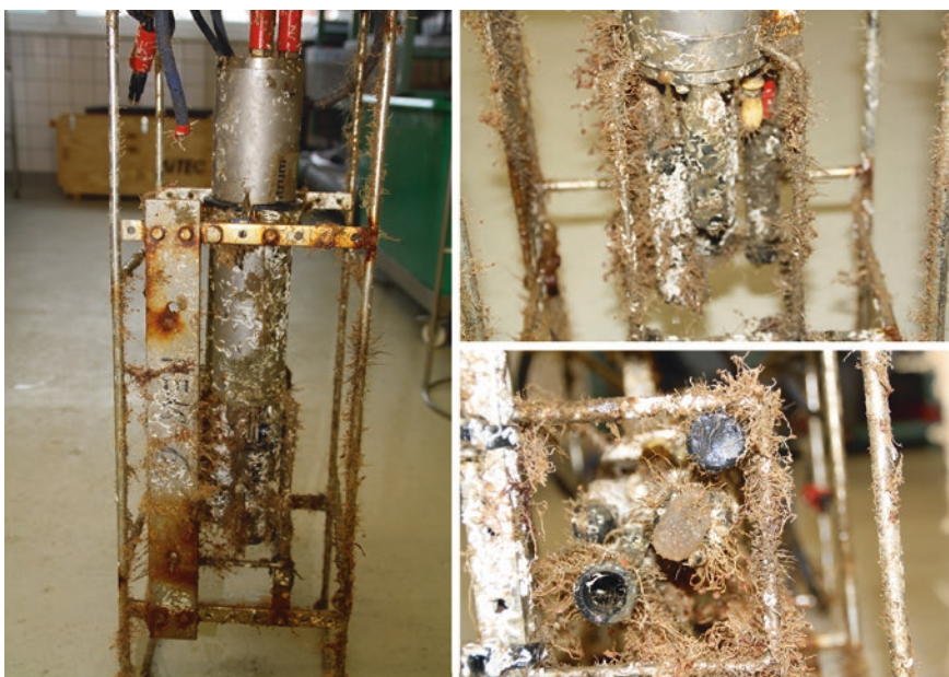
Abb. 11 CTD-Sensoreinheit nach 8 Monaten Exposition in den flachen produktiven Gewässern der südlichen Nordsee
