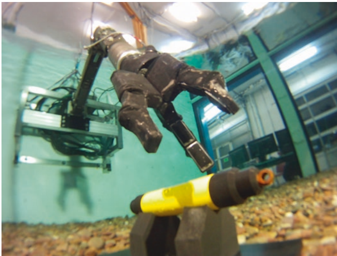
Abb. 8 Ein Standard-Industriemanipulatorarm von Shilling Robotics, USA, umprogrammiert und mit taktilen Greifern und Kameras ausgestattet während einer autonomen Objekterkennungs- und Greifaufgabe
