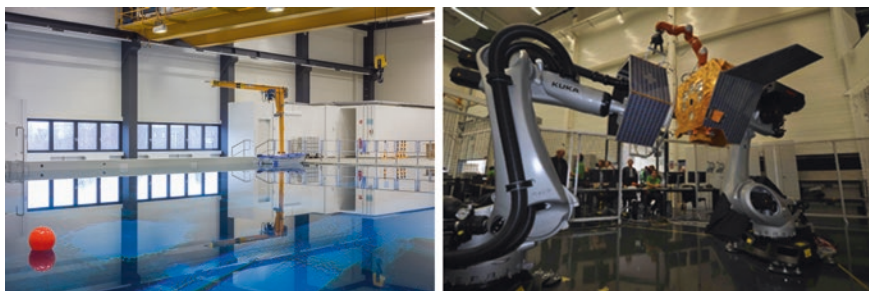
Abb. 2 Links: Becken für Tests von Unterwasserfahrzeugen am DFKI; rechts: Infrastruktur zur Simulation der Dynamik von schwebenden Basen für Raumfahrtanwendungen und fliegende Roboter am DLR
