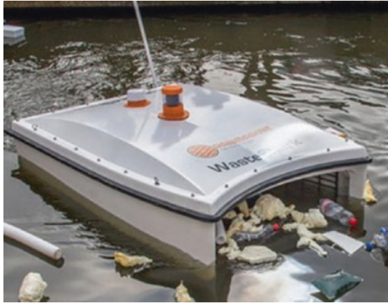
Abb. 2 Robotersystem Waste-Shark. Eine Studie über einen autonomen Roboter zur Sammlung von an der Wasseroberfläche schwimmender Abfall in Häfen und anderen begrenzten maritimen Umgebungen.
