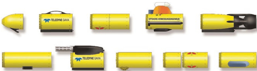
Abb. 2 Zwei verschiedene Konfigurationsoptionen für das Gavia AUV von Teledyne. Jedes Rumpfsegment enthält eine individuelle funktionale Komponente und kommt mit seiner elektro-mechanischen Schnittstelle. (Bild mit freundlicher Genehmigung von Teledyne-Gavia)
