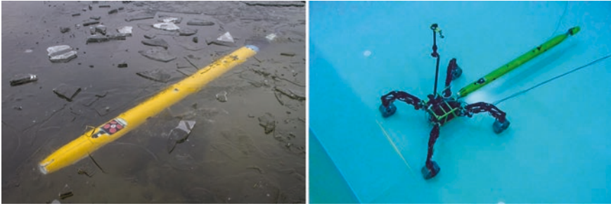
Abb. 7 Der Unterwasserroboter Leng. Das System wurde für eine Studie zur Erforschung der Tiefen von außerirdischen Ozeanen eingesetzt (Studie für die deutsche Raumfahrtverwaltung), wurde aber hier verwendet, um Multi-Roboter-Szenarien zu simulieren. Das rechte Bild zeigt den Roboter Leng beim Andocken an den Roboter Sherpa-UW, um große Datenmengen auszutauschen, was über Funkverbindung im Wasser ineffizient ist
