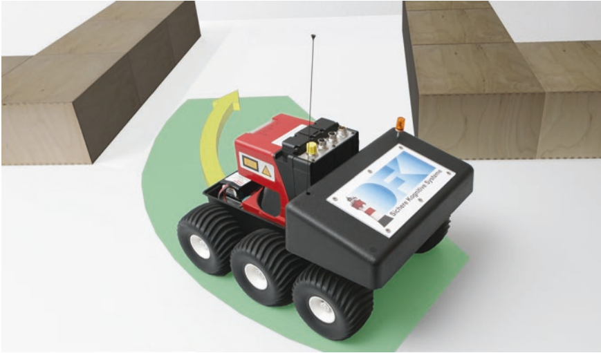
Abb. 3 Der SAMS-Demonstrator fährt eine Rechtskurve und die kollisionsfreie Sicherheitszone dieser Bewegung. Wenn es ein Hindernis in der Sicherheitszone gäbe, würde das AGV (Autonomous Ground Vehicle) stoppen. Die Eingabe für den Algorithmus ist die Geschwindigkeit und Winkelgeschwindigkeit (gelber Pfeil), angegeben mit Unsicherheit durch Intervalle. Die Ausgabe ist die Sicherheitszone (grün) als Array von Abständen in verschiedene Richtungen relativ zum Fahrzeug. Grafiken von [26]
