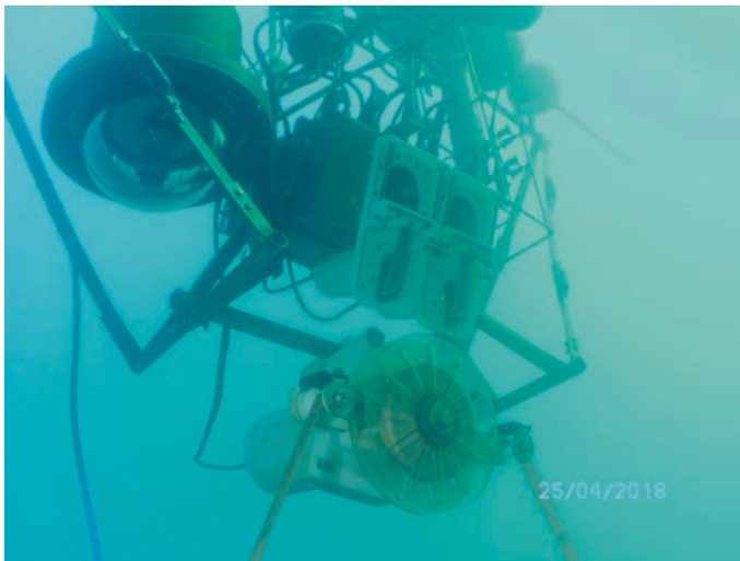
Abb. 7 Unterwasser-Stereoskopie-Observatorium RemOs1 zur Messung von Fischreichtum, Artenzusammensetzung und Häufigkeitsverteilung der Fischlängen
