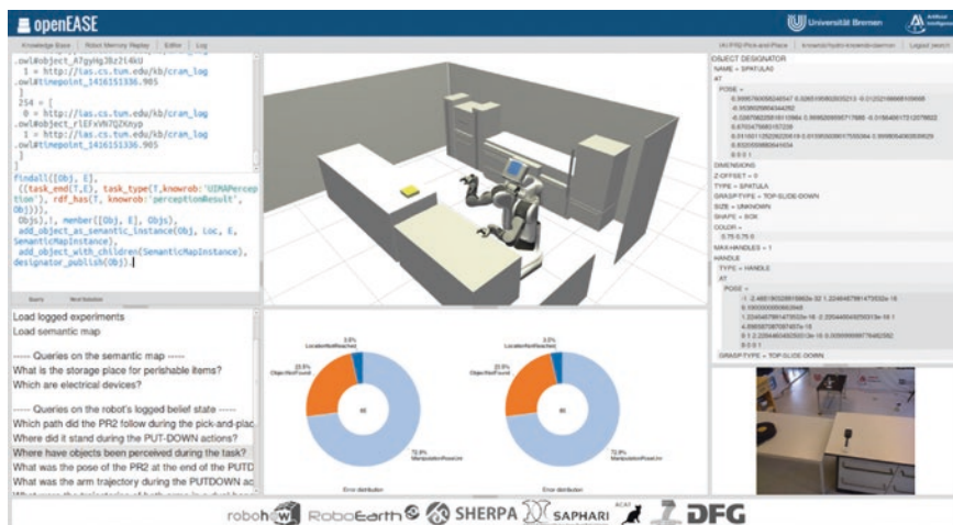
Abb. 1 openEASE ist ein webbasierter Wissensdienst, der Roboter- und menschliche Aktivitätsdaten bereitstellt. Es enthält semantisch annotierte Rohdaten, bietet eine leistungsfähige Abfragesprache und Inferenzmaschine sowie Visualisierungstools
